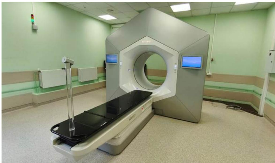
*КТ аппарат SOMATOM go. Sim с функцией сканирование в режиме 4D с управлением дыхательными движениями*
